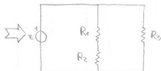
$$R_{TOT} = \frac{(R_1 + R_2) \cdot R_3}{R_1 + R_2 + R_3}$$
